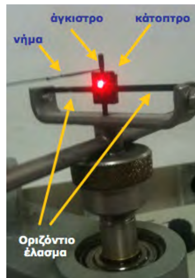
Σχήμα 4. Ο μηχανισμός στήριξης του κάτοπτρου και το άγκιστρο στο οποίο τοποθετείται το νήμα.
